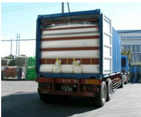
往路輸送時のコンテナに製品（樹脂）が 充填されている様子
